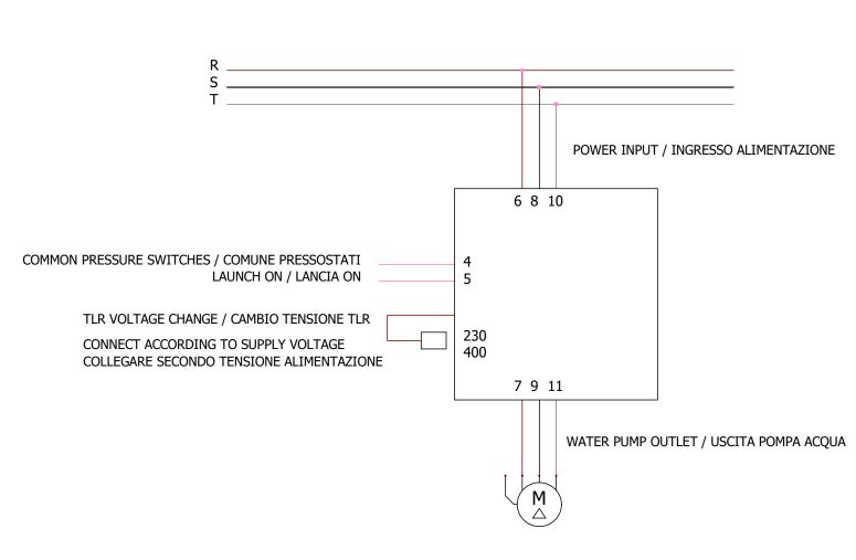
M1 -Water pump outlet / Uscita pompa acqua
